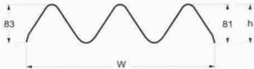
Gambar 22 Penampang Melintang Lempeng Balok Tiga Lengkung ( Thrie Beam )
