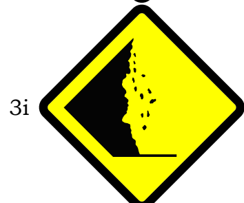
Peringatan Bagian Tepi Jalan Sebelah Kiri yang Rawan Runtuh
